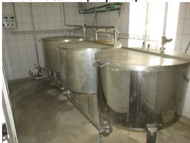
Ad 20 CIP sistem za pranje + 3 spremnika
